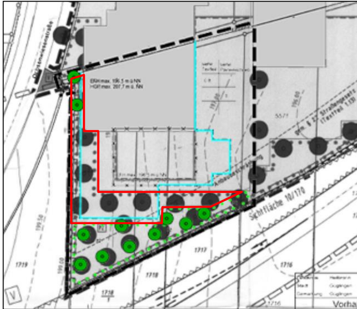
Abb.: Überlagerung des rechtskräftigen Bebauungsplans (schwarz-weiß) und der 3. Änderung (farblich) mit Markierung der überplanten Fläche mit Pflanzzwang (rot umrandet) – unmaßstäblich
